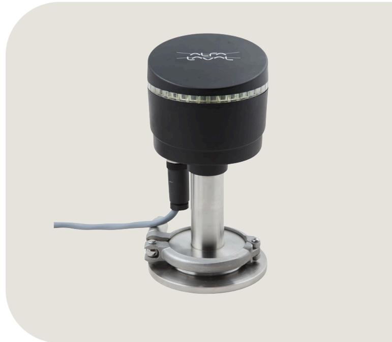
und/oder Steckverbinder. Die Sensoreinheit verfügt über einen Messfühler, der sich im Inneren des Verarbeitungstanks befindet und mit einer Sensorplatte verbunden ist, die das Signal verarbeitet und an die speicherprogrammierbare Steuerung (SPS) weiterleitet.
