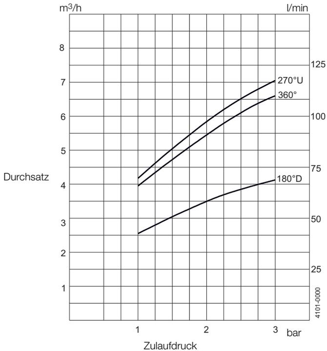
Bei Clip-On-Modellen erhöht sich die Durchflussmenge um ca. 0,5 m³/h.
