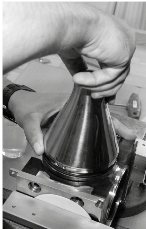
7. Montiertes Planetengetriebe in den Getriebering (13.2) einsetzen.
