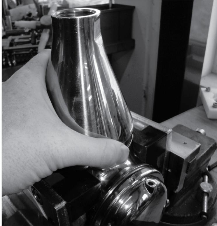
6. Die montierten Oberteile von der Maschine entfernen (senkrecht anheben)
