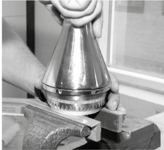
10. Den Kegel (1.1) mithilfe des Ringschlüssels (TE81B141 oder TE81B159) anziehen, bis ein Widerstand zu spüren ist, und noch ein wenig fester anziehen. Der Widerstand ergibt sich aus dem Kontakt zweier Oberflächen.
