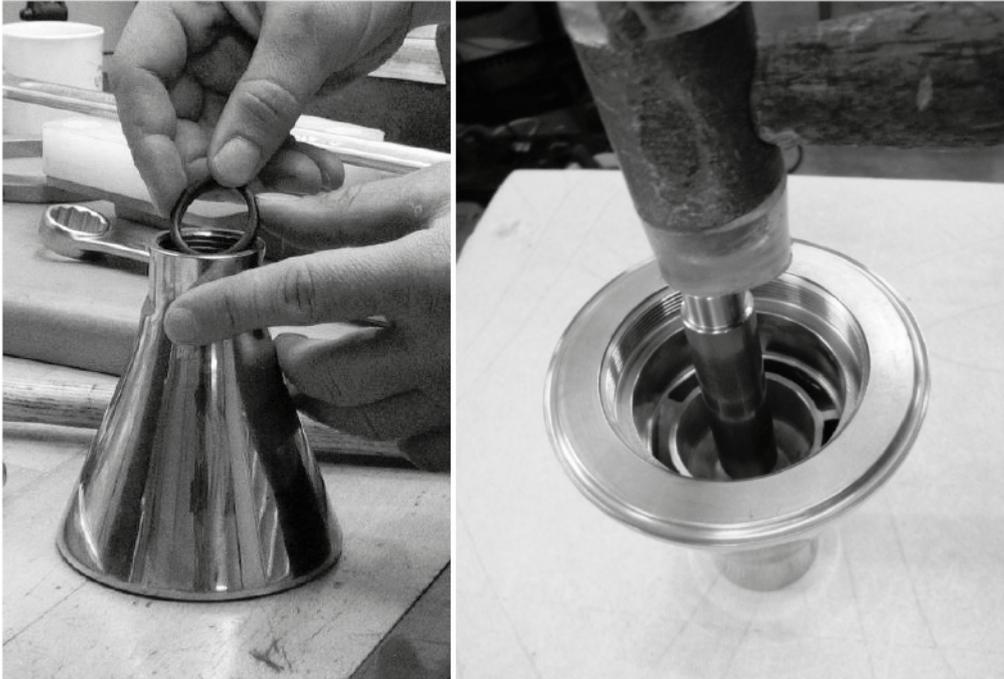
10. Buchse (1.2) mithilfe des Austreibers (TE81B139) aus dem Kegeloberteil stoßen.
