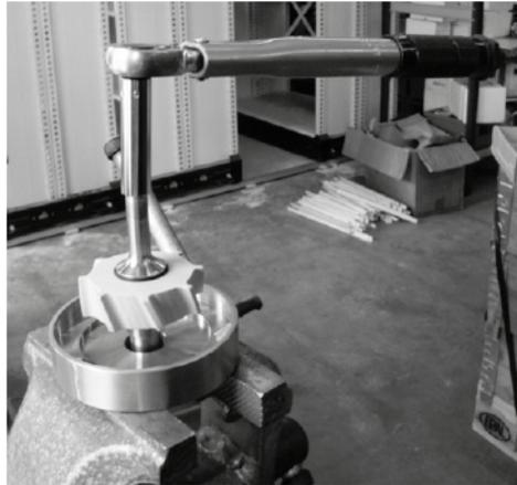
5. Das Wellenende (3.4) mithilfe des Drehmomentschlüssels (TE81B156) und des NV9 Steckschlüssels (TE81B158) in die Turbinenwelle (3.1) schrauben. Mit einem Drehmoment von 10–12 Nm anziehen.
