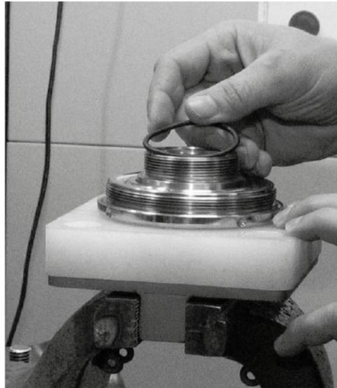
6. Vorbereitungen vor der Befestigung des Kegelradgetriebes (14) am Düsenkopf (18): Es wird empfohlen, das Gewinde des Düsenkopfes mit Lebensmittel-/FDA-konformem Fett zu schmieren. Durch die Schmierung wird das Risiko des Gewindeverschleißes reduziert. Das Fett ist zwischen den O-Ringen eingeschlossen und kommt daher nicht mit dem Reinigungsmittel in Kontakt.
