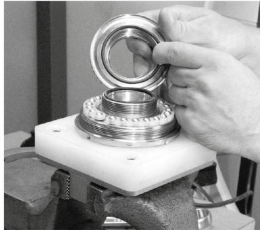
10. Kegelradgetriebe (14) von Hand auf das Gewinde des Düsenkopfs (18) schrauben.
