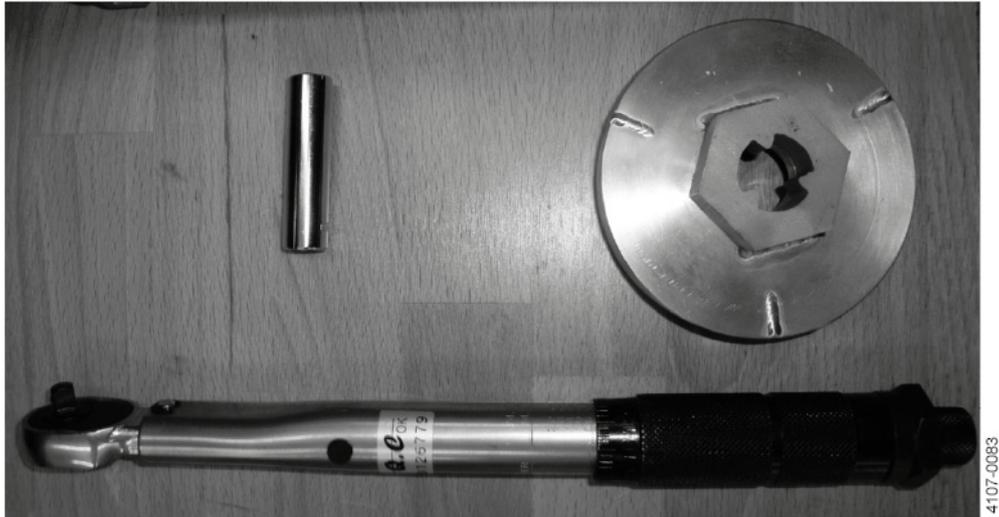
1. Die Befestigung für die Turbinenwelle (TE20J392) im Schraubstock festziehen. Wellenende (3.4) mithilfe des Drehmomentschlüssels und des langen Steckschlüssels NV9 (TE81B156 + TE81B158) lösen und per Hand abschrauben.
