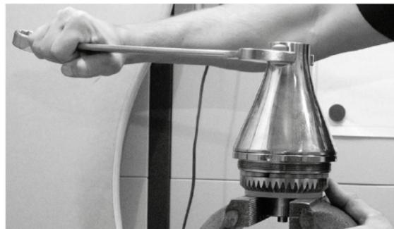
11. Sicherstellen, dass der Turbinensatz im Oberteil frei beweglich ist.
