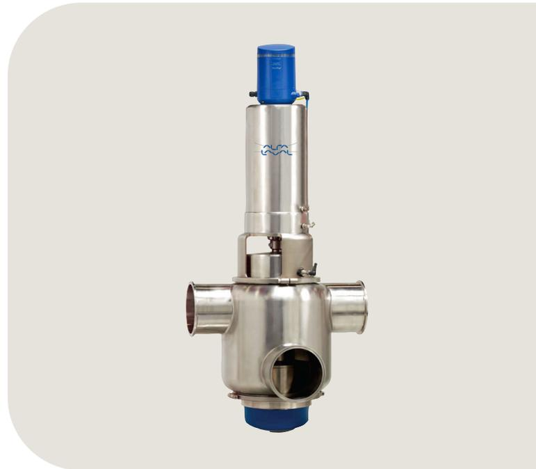
durch dasselbe Ventil geführt werden, oder für den sicheren Umgang eines Produkts, während der andere Ventiltteil gereinigt wird – ohne dass dabei ein Kreuzkontaminationsrisiko besteht. Beim Sitzhub des unteren Ventilkegels reinigt das Ventil gleichzeitig die untere Ventilkegeldichtung sowie die Dichtlippe des unteren Dichtungselements.
