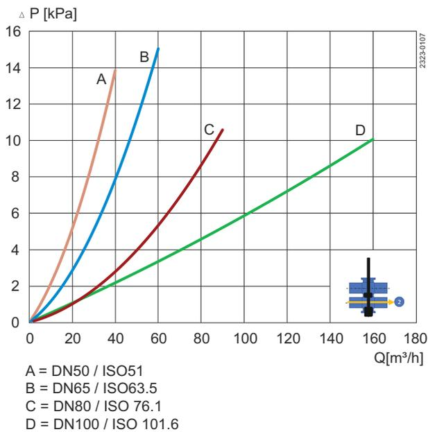
Abbildung 3. Druckabfall-/Leistungsdiagramm, unteres Gehäuse
