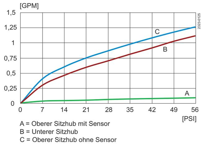
Abbildung 13. Unique Mixproof Process ISO101.6/DN100    Abbildung 14. Unique Mixproof Process 4"
