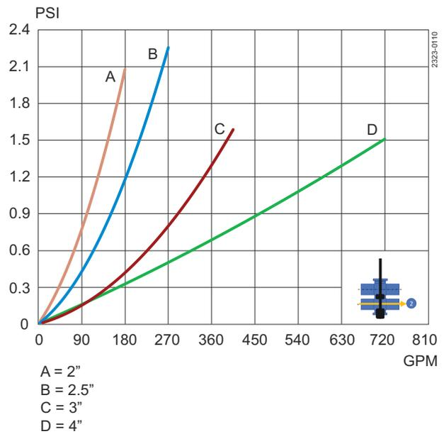
Abbildung 4. Druckabfall-/Leistungsdiagramm, unteres Gehäuse
