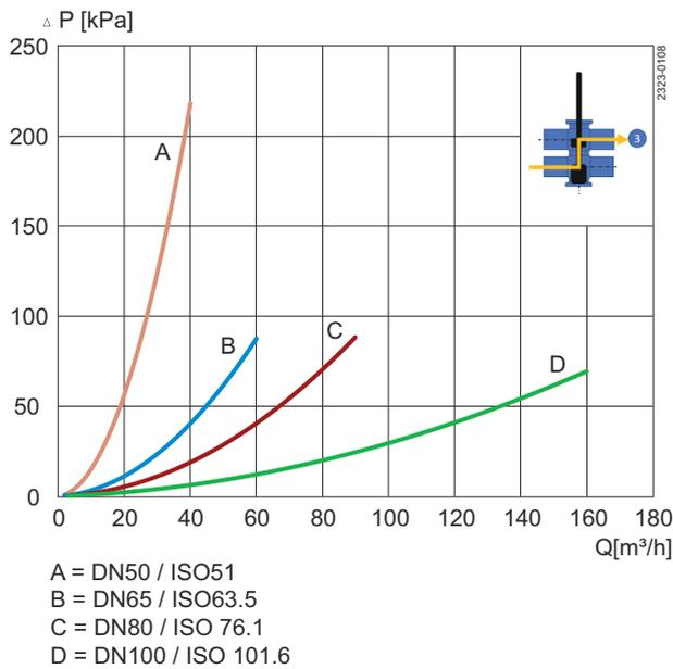
Abbildung 5. Druckabfall-/Leistungsdiagramm, zwischen den Gehäusen
