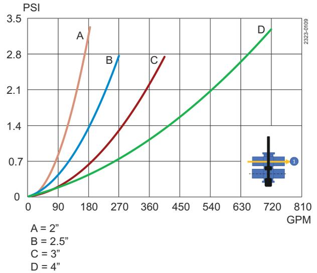
Abbildung 2. Druckabfall-/Leistungsdiagramm, oberes Gehäuse
