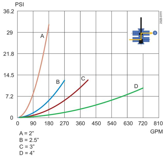
Abbildung 6. Druckabfall-/Leistungsdiagramm, zwischen den Gehäusen
