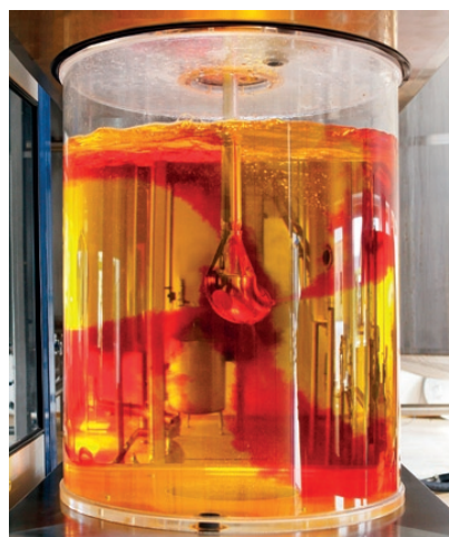
Iso-Mix Rotations-Jet-Mixer mischen Flüssigkeiten, Gase oder Pulver durch rotierende Strahldüsen ein, ohne eine Chargenrotation zu bewirken.
